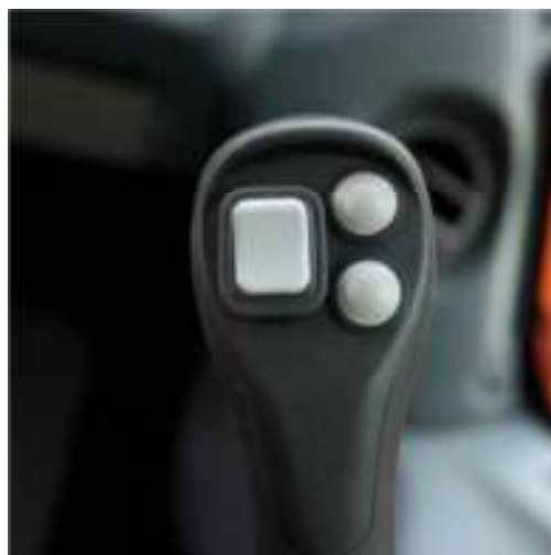
Výrazná signalizace úsporného provozu. Volba směru jízdy a druhého módu přímo na ovladači
