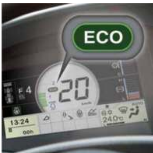
Výrazná signalizace úsporného provozu. Volba směru jízdy a druhého módu přímo na ovladači
